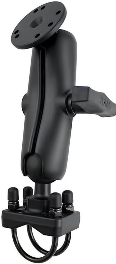
Bügelbasis, für Rohrdurchmesser 3,2-3,8 cm (1,25-1,5 Zoll), 2,25-Zoll-Kugel (Größe D), mit Verbindungsstück, 16,7 cm, und runder Basis, 9,35 cm
