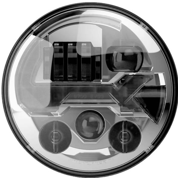
12 V, Abblend- und Fernlicht, mit Tagfahrlicht, Standlicht und Blinker, ECE-Straßenzulassung (Reg. 7, 87, 112), verchromte Einfassung, Set mit 2 Scheinwerfern (links und rechts)
