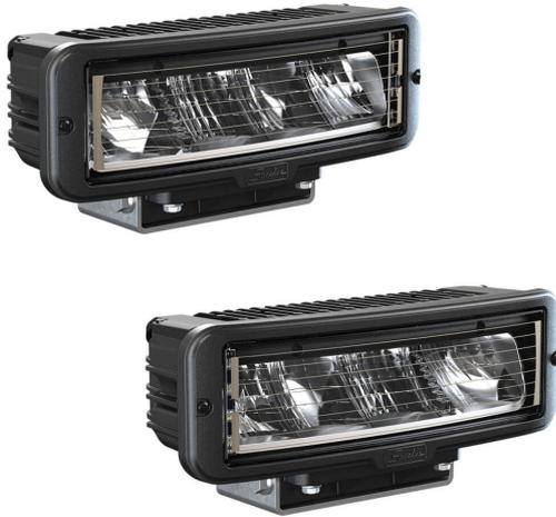
12 V, Abblend- und Fernlicht, mit Tagfahrlicht und Standlicht, mit Fahrtrichtungsanzeiger, ECE-Straßenzulassung (Reg. 6, 7, 87, 112), mit beheizter Frontlinse, Set aus 2 Scheinwerfern (links und rechts), Rechtsverkehr
